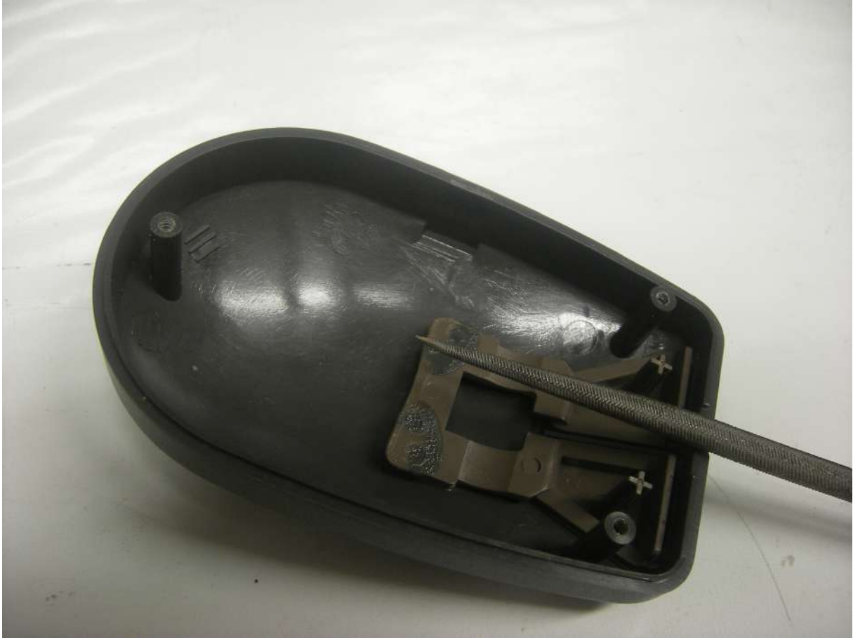
De behuizing aanpassen voor de "nieuwe" kabel
