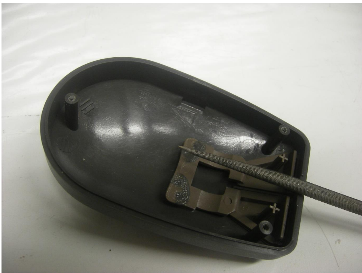
De behuizing aanpassen voor de nieuwe kabel.
